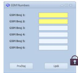
*Uređaj omogućava autorizovani pristup, koji se bazira na identifikaciji po GSM brojevima čime je isključena mogućnost zloupotrebe.*
